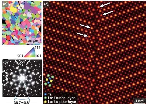
図 (b) は粒界直上から得た電子回折図形であり、[001] 軸周りに 36.7° の回転角を持つ Σ 5 対応粒界であることがわかる。この領域から得られた原子分解能 ADF-STEM 像を図 (c) に示す。原子分解能での直接観察により、映進対称を持つ Σ 5 [001] / (130) 対称傾角粒界であることがわかる。ADF-STEM 像の強度分布からもわかるように、A サイトは La-rich 層と La-poor 層が c 軸方向に沿って交互に積層しており、Li イオンは La-poor 層面内を2次元的に拡散する。しかしながら、矢印で示す粒界直近では、La-poor 層に La が濃化しており、粒界を横切る方向への Li 拡散を阻害していると考えられる。このように、局所的な粒界原子構造を直接観察することにより、粒界が Li イオン伝導を阻害する原子レベルのメカニズムが明らかとなった。本研究は NEDO の RISING2 プロジェクトで行われた。
