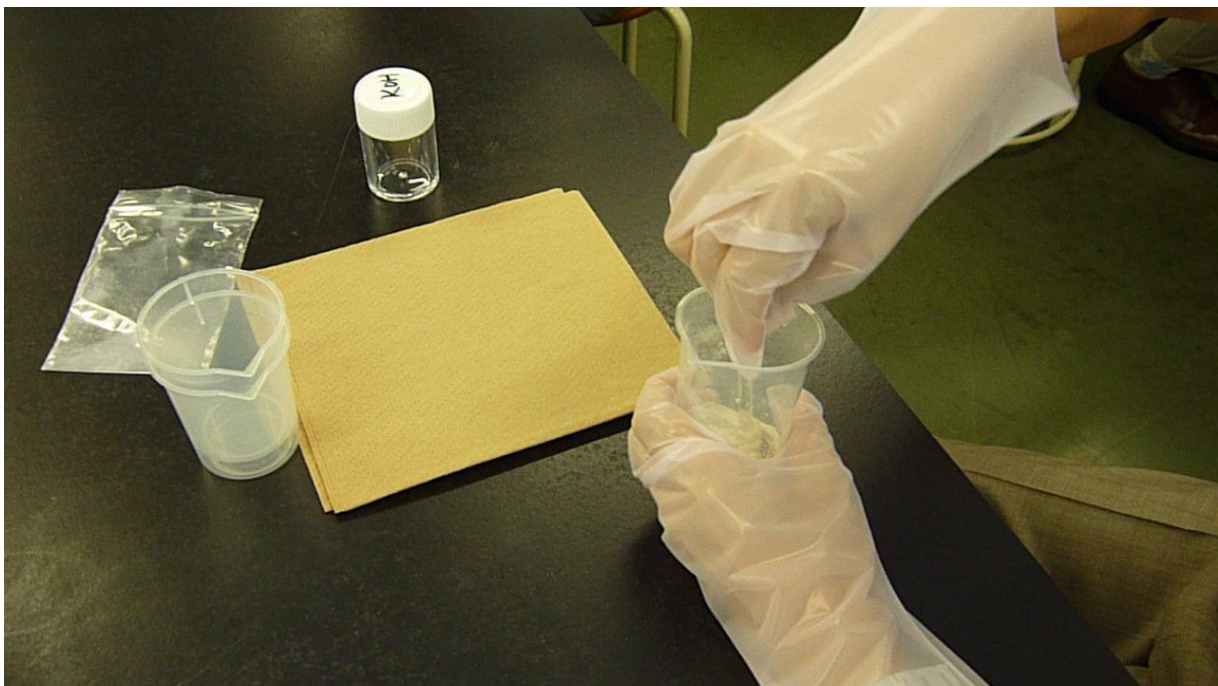
○メタカオリンと KOH（水酸化カリウム）水溶液と K_2O \cdot nSiO_2 （水ガラス）を混合
