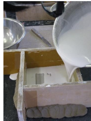
写真 4, 5 石膏を攪拌し、流し込む様子
