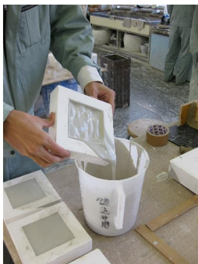
写真9,10 排泥する様子と排泥した後の様子
