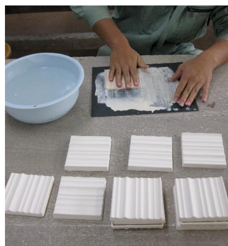
写真13 薄くするために削る様子
