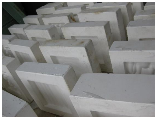
写真6 完成した鑄込み型
