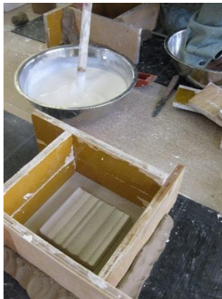
写真 4, 5 石膏を攪拌し、流し込む様子
