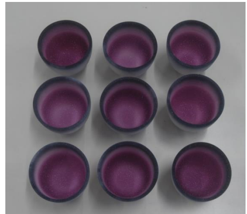
図3 美しいルビー微結晶で覆われたアルミナるつぼ (Fig.3 Photograph showing the alumina crucibles with tiny ruby crystals)
