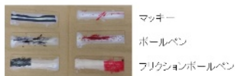
小型の紫外線ランプ(6W)を使用していたので 強力な紫外線ランプ(400W)に変更して実験した → 汚れを分解することに成功した
