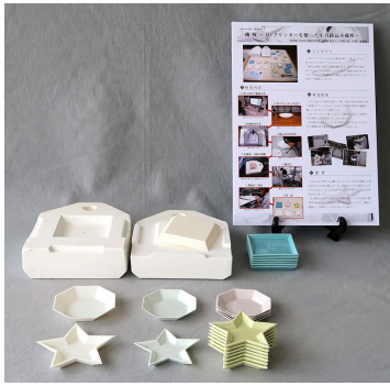
No.1 「挑戦～3Dプリンタを使った圧力鋳込み成形」 佐賀県立有田工業高等学校
