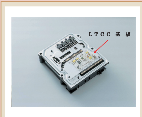
図1 LTCCをECU基板に用いたABSモジュールの外観
