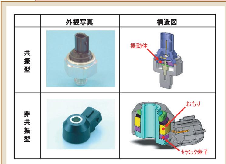
図2 ノックセンサの外観と構造
