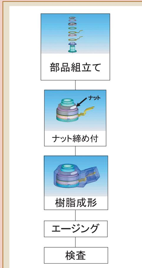
図4 非共振ノックセンサの製造プロセス
