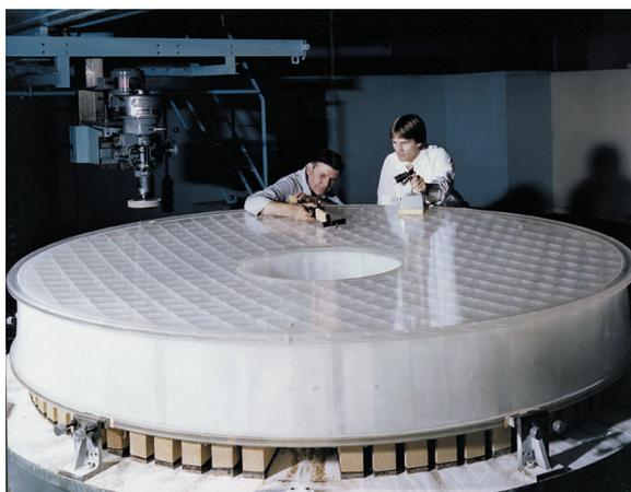
図2 ハッブル宇宙望遠鏡の主反射鏡
