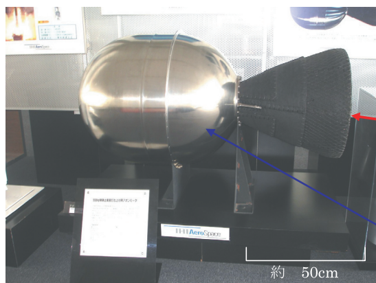
図1 550kg 級静止衛星打ち上げ用アポジモーター
