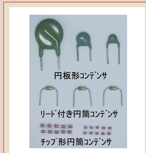
図1 粒界絶縁型コンデンサ
