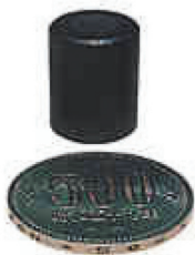
BWR燃料ペレット 直径：約 9.6mm 高さ：約 10mm チャンファ付
