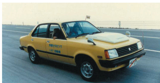
図3 桜島溶岩道路を疾走するオールセラミックエンジン車
