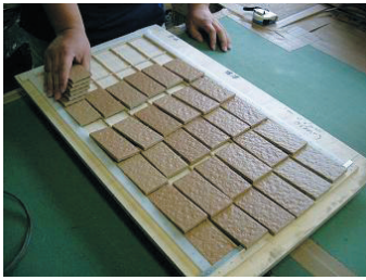
図9 パラタイルをシートパック用の型枠に並べる
