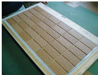
図10 型枠へセット完了
