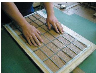
図11 タイルとタイルの間には目地と呼ばれる隙間があり、そこへ発泡ポリエチレンなどで作られた角棒を挟み込む
