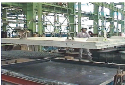
図19 PCa 版の脱型
