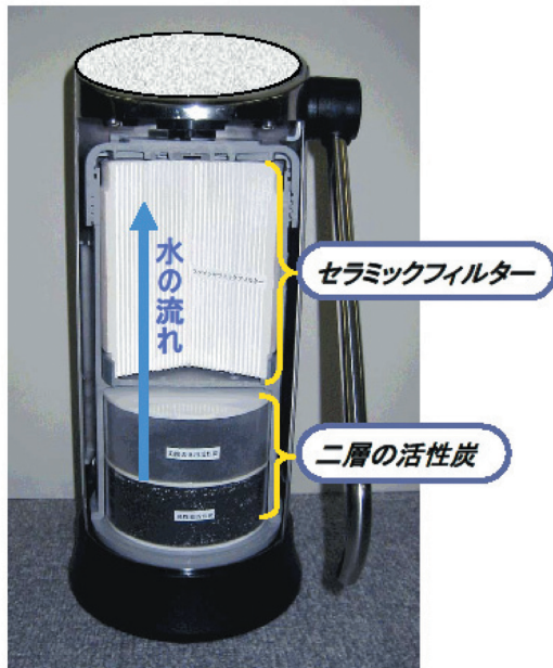
図1 浄水器の構造
