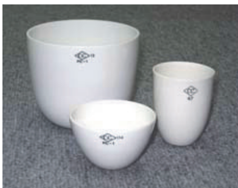
図1 ルツボ：理化学用磁器（ムライト質）
