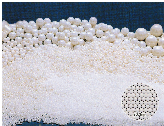
図2 T-TZP（イットリア安定化ジルコニア）製メディア写真 φ 0.1mm 未満のメディアも開発されている。
