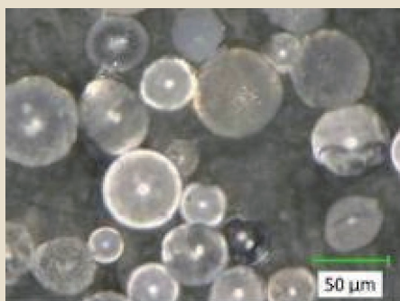
図1 球状セラミック粒子の顕微鏡像
