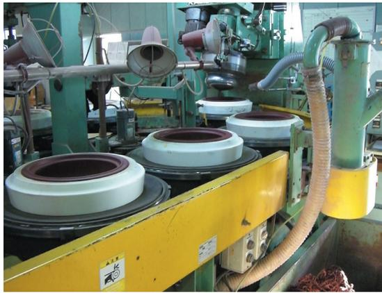
図2 ローラーマシンによる土鍋の成形
