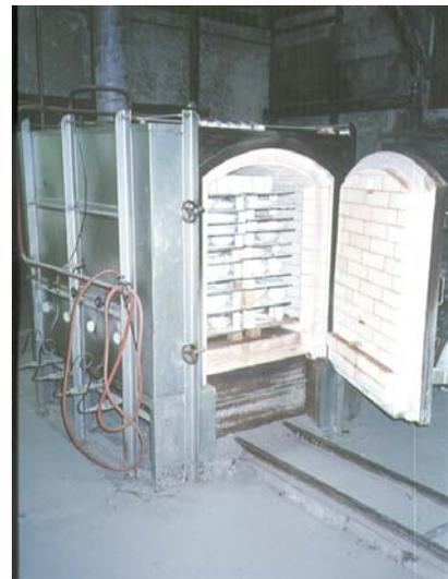
写真11. プロパンガスを燃料とするガス窯
