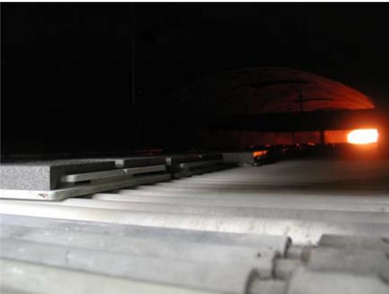
写真 13. タイルを焼成するための工業生産用トンネル窯
