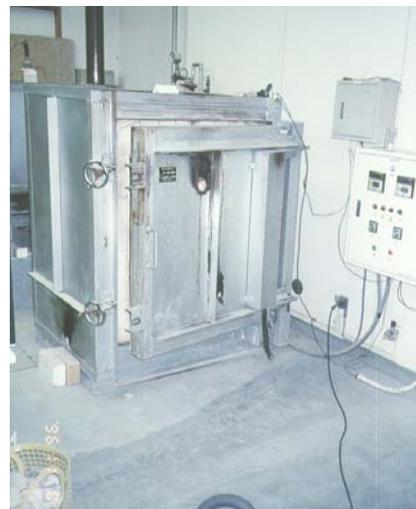
写真 14. 自動焼成装置と共に使用される電気窯
