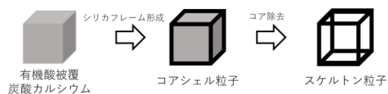
Fig.1 無機粒子テンプレート法を応用したスケルトン粒子の合成
