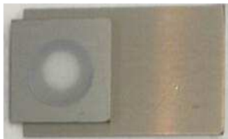
図1 接合強度評価用部材
