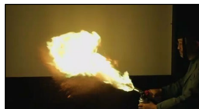
粉塵爆破の実験
