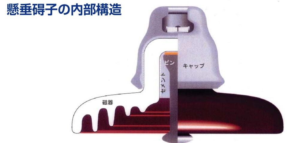
■12トン懸垂碍子(1990年 日本ガイシ(株)) 笠状の磁器の両側に金具を接着し、複数個を連結して送電線の絶縁支持に使用する。 展示品の課電破壊荷重は120kN(12トン)である。
