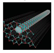
ギャップが 6.5 eV であるのに対して、一次元規則結晶では 3.0eV と算出され、ワイドバンドギャップ半導体への応用も期待される。モノクロメーター搭載 STEM を用いた電子エネルギー損失分光法 (EELS) により精密計測を行ったところ、理論計算と整合する結果が得られた。
