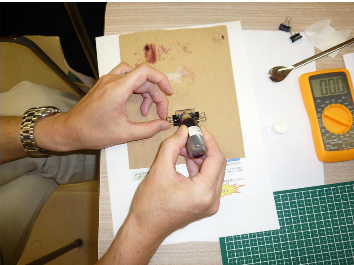
○ヨウ化物電解質溶液が全体になじんだら太陽電池の完成
