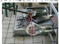
内かぶせ:色ガラス種を使って下玉を作り、その上に透明ガラスで上玉を付ける。
