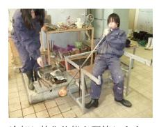
紙リンを当てて冷却し軟化状態を調節します。 表面のみが固まり、内部が軟化した状態で吹かないと、片肉や底抜け、吹き過ぎが生じます。 十分に加熱軟化させることがポイントですが、 初学者にはやや困難です。軟化が不十分なら一度に吹かさず、竿の角度を立て、少しずつ吹いては玉先を紙リンで冷却するという作業を繰り返させます。ここを丁寧にやらないとコップの口になる竿元が肉厚、底になる玉先が肉薄になってしまいます。
