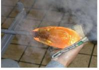
歪みを直そうとして無理に紙リン(手)でガラスを押さえると、竿の回転のため、竿を軸対称とする全方向から中心に向かってガラスを押したのと同じ効果になるので、逃げ場を失った軟化ガラスは軸方向に移動します。それゆえ初学者は玉が細長くなりがちです。重力を駆動力に使ってガラスを変形させるには十分な加熱と軟化、加えて紙リンと竿の距離を一定に保つ工夫が必要なのです。距離を保つコツは、手で竿を回転させるのではなく、両肩の前後の動きで竿の回転を調整し、左右両腕を同じように動かすことです。このほか、手を自由に使うために、ガラス玉の極近くに着席させることが重要です。(吹き)
