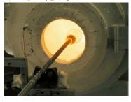
転させて落下を防ぎます。もし落下速度が大きいと玉は下に落ち、竿の回転速度が大きいと玉は遠心力で振り回されて変形して落ちます。二つの速度が一致すると、右回転なら玉の中心が左水平にずれたところでガラス玉が安定します。玉の状態をよく観察させ、軟化状態に応じた適切な回転速度になるよう調整します。竿の回転を覚え、十分に軟化した状態を保つことができないと、以下の操作がうまく行きません。
