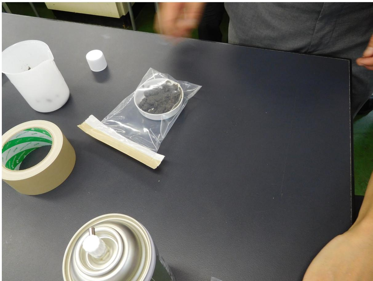
○対照実験として、何も入れていない平皿をポリ袋に入れ、同様に二酸化炭素ガスを吹き込み、密封する。
