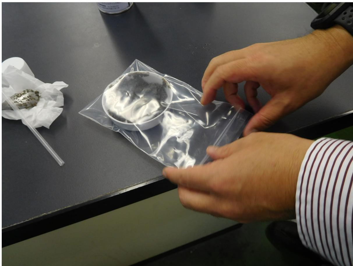
○ポリ袋の中の空気を抜いた後、ポリ袋がパンパンになるまで、二酸化炭素ガスを吹き込み、密封する。
