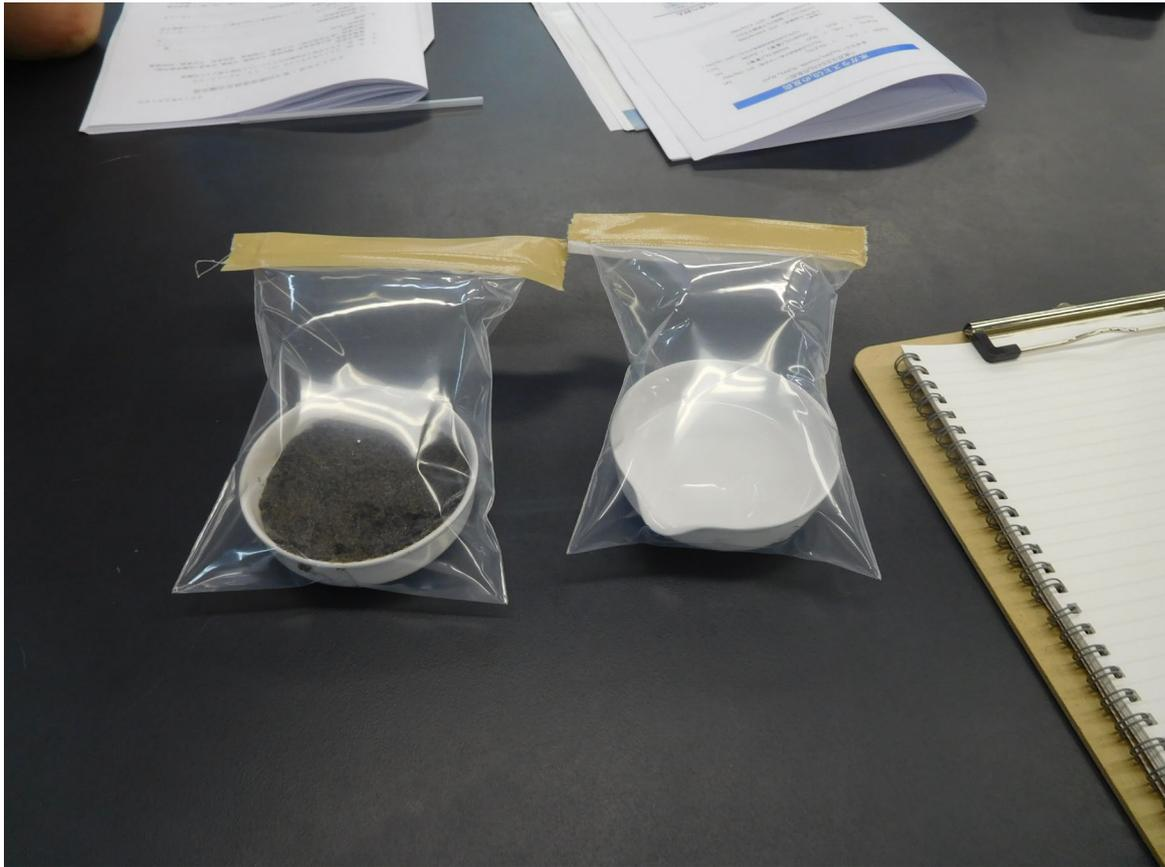
○ポリ袋中の混合物表面に白い析出物（二酸化炭素と水ガラスが反応して生成する炭酸水素ナトリウム）が生成してくることがわかる。また、混合物が入ったポリ袋はパンパンの状態から、しぼんでくる様子が見られる。
