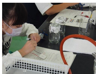
写真5 サーモ・モジュールを用いた発電実験 Photo.5 Power generation using the thermoelectric module
