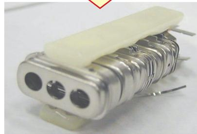
ガラスに、電極の脚部を埋め込む。高温加熱や埋め込み作業に対し、適度な粘性特性になっている。
