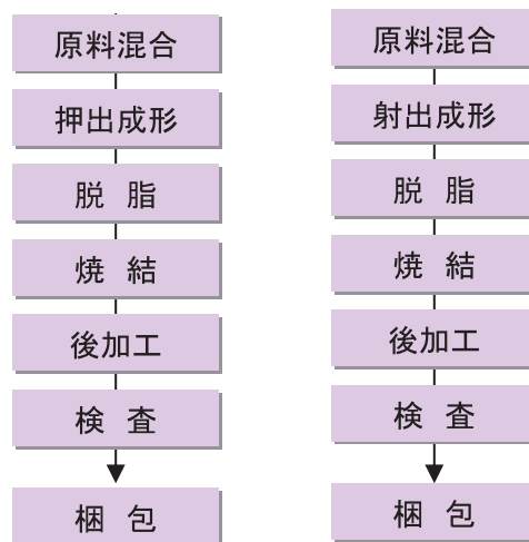
図3 フェルール製造プロセス
