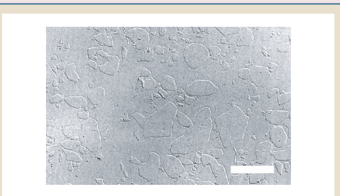
図5 アルミナ/ガラス複合体の微構造 (Bar=5 \mu m)
