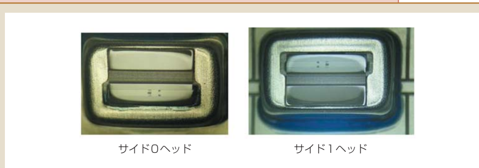
図9 FDD用磁気ヘッド完成写真
