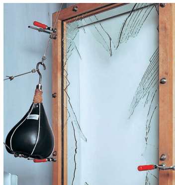
フロート板ガラス(5ミリ) 鋭利なガラス片が落下し、大きな開口となる。
