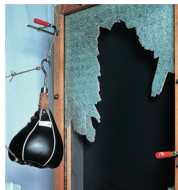
強化ガラス(5ミリ) 破損すると、ガラスが飛散し、加撃物が貫通する。
