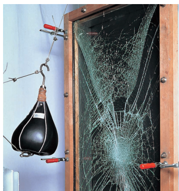
合わせガラス(3ミリ+3ミリ) ガラス片も飛散が少なく貫通もしにくい。
