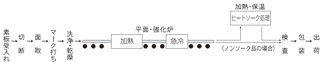
図5 建築用強化ガラスの製造工程図
