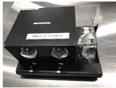
図6 自動車ヘッドライトモデル内蔵灯体部の写真 3連ヘッドランプモデルで右端部はハーフカット透過断面模型の正面写真
