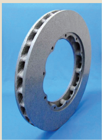
図1 ベンチレーテッドタイプ ブレーキディスク
