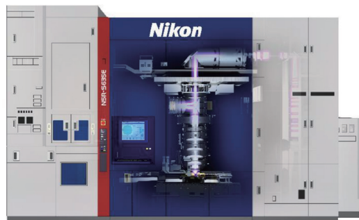
図1 スキャナーの内部構造（概略図）
