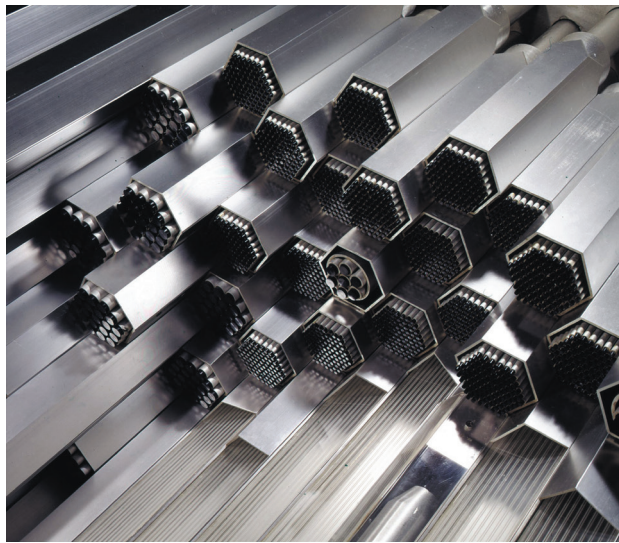
図3 高速増殖炉(FBR)の制御棒
