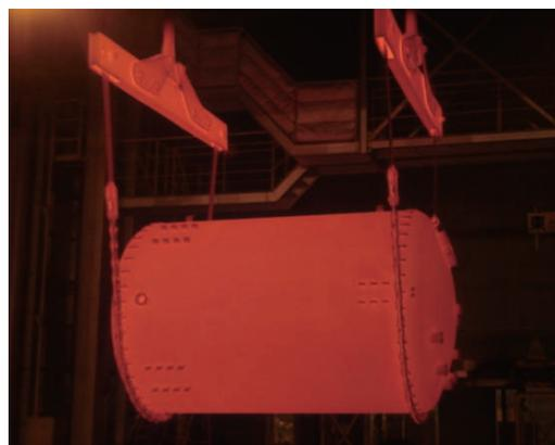
図3 焼成されるグラスライニング製反応機
