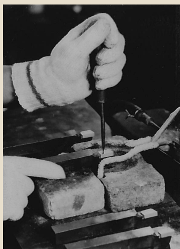
写真2 セラミックス工具をホルダーにロウ付けする作業
