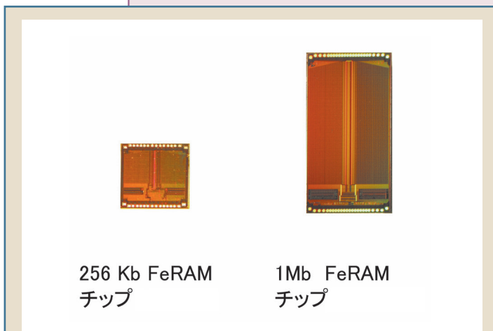
図2 量産されているFeRAMチップの写真
