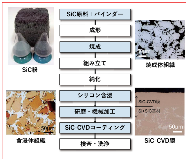
図4 高純度反応焼結SiCの製造プロセス
