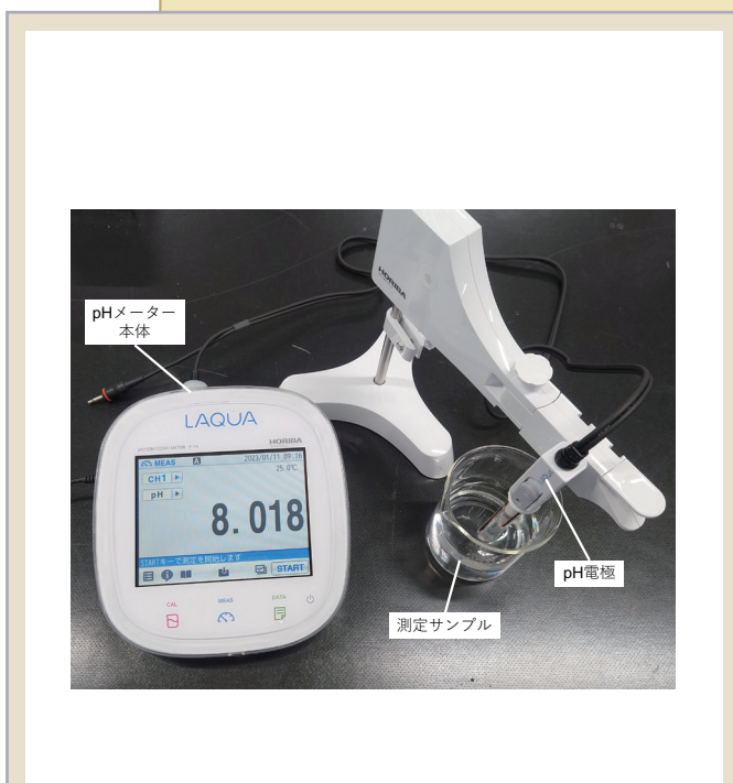
図1 実験室用 pH メーターの例
