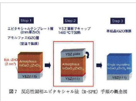
図7 反応性固相エピタキシャル法 (R-SPE) 手順の概念図
