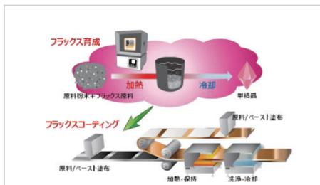
図4 一般的なフラックス法(上段)とフラックスコーティング法(下段)の概念図
