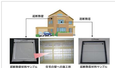
図12 複合化技術および真空セグメント化技術開発の成果例と住宅向け超断熱材料の実用化イメージ。
