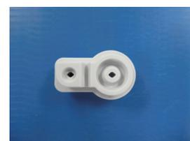
図 水素燃料で焼成した点火プラグ用碍子
